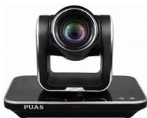
Caméra ProAV PTZ. 50 ips. Capteur Sony. Zoom optique 30x, 4 canaux de sortie vidéo simultanée : SDI/DVI-I/HDMI/YPbPr. Champ de vision très large de 70°. Capteur CMOS nouvelle génération Sony 3,27 MP 1/2,8". L Pan 356°. Inclinaison 145°.
